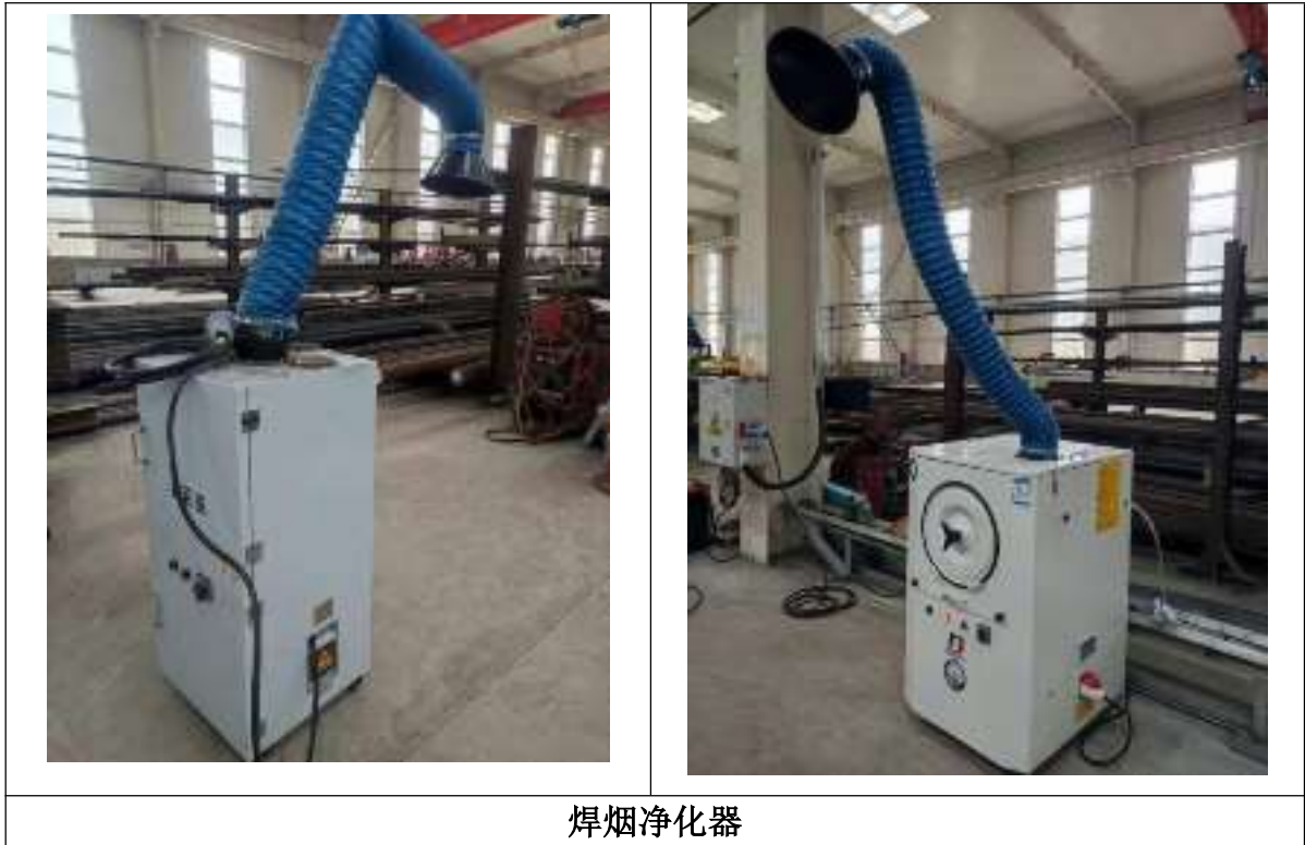
图 3-1 项目废气污染物处理措施现场照片
