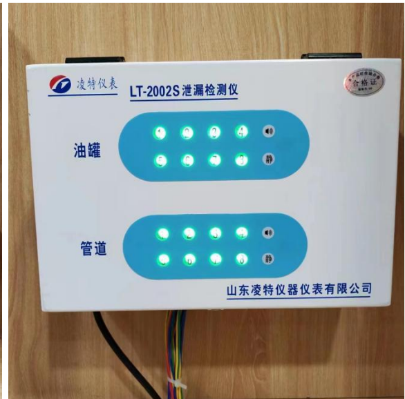
图 3-3 在线泄漏检测仪
